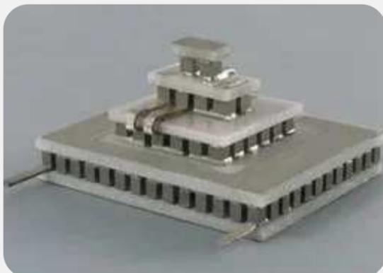
Многокаскадный термоэлектрический модуль
